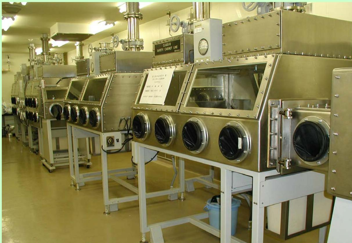
大型オートクレーブ、処置用グローブボックスがラインに直結している。
