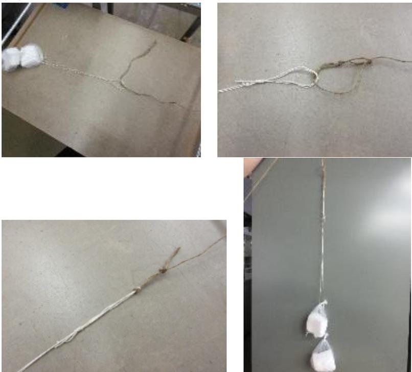
(3) マイナスドライバーで汚水枳の蓋を開け、トラップ採水用器具を汚水枳へ挿入する。
