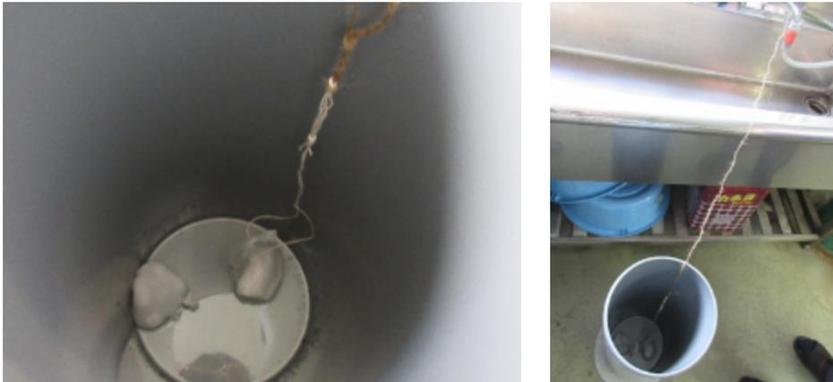
(5) トラップ採水用器具が水に浸かるまで挿入し、適当なところで麻紐を結び付けて固定する。
