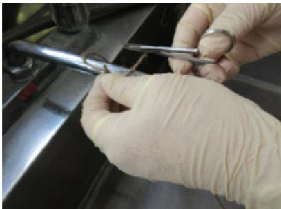
(7) トラップ採水用器具をゆっくりと引き上げ、紙コップに回収し、余分な紐を切る。
