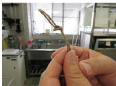
(2) トラップ採水用器具の輪に麻紐を通し、先端を麻紐の輪に通し連結する。
