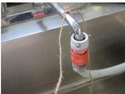
(6) 翌日、トラップ採水用器具を回収する。固定していた麻紐を切る。
