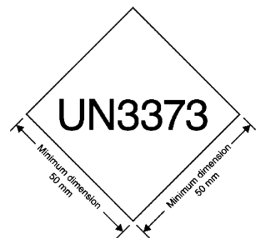
図 9:カテゴリ B の感染性物質に使用しなければならない表示の例
